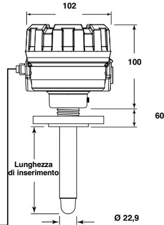
**Sensore ad estremità sferica TMA remoto con connessione flangiata**
