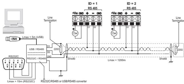
Alle due estremità della rete devono essere presenti le terminazioni di linea. Per polarizzare la linea durante i periodi di non trasmissione si usano dei resistori collegati tra le linee di segnale e l'alimentazione. Il numero massimo di dispositivi collegabili alla linea (Bus) RS485 dipende dalle caratteristiche di carico dei dispositivi da collegare.
