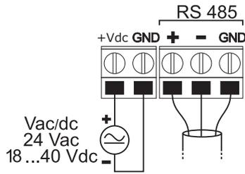
Grazie all'uscita RS485, più strumenti possono essere collegati per formare una rete. Gli strumenti sono collegati in successione mediante un cavo schermato con doppino attorcigliato per i segnali e un terzo filo per la massa.
