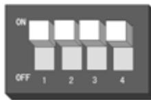
Chiave 1: [ON] Alimentazione 24V per uscita allarme ALML | [OFF] no connessione
