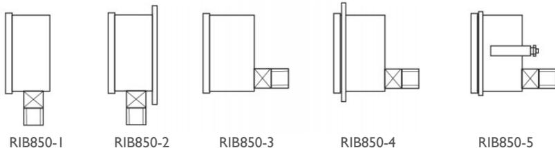
RIB850-1 Locale, attacco radiale. RIB850-4 Incasso flangia 3 fori, attacco posteriore.
