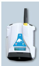
Unità di monitoraggio GSM/GPRS comprensiva di 4 ingressi digitali, 2 ingressi analogici, 2 uscite digitali, display LCD, sensore di temperatura, ingresso per sensore NTC esterno, batteria, modulo GPS (opzionale).
